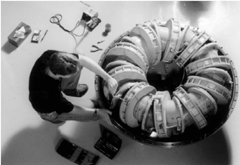
Abb. 7: Streufeldarmes, toroidales Magnetsystem für den SMES-Kompensator
