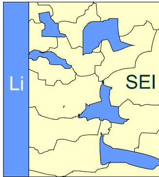
Abb. 3: Modell der Lithiumabscheidung aus aprotischen Elektrolytlösungen nach /SELIM 1974/
